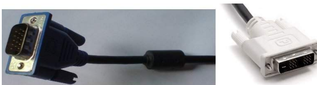
Slika 7.4.3 Muški VGA priključak (levo) i muški DVI priključak (desno)
