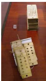
Slika 2.3.1.2 Dve vrste bušenih kartica korišćenih za programiranje mašine. U prvom planu su operativne karte za unos instrukcija, a u pozadini promenljive karte za unos podataka
