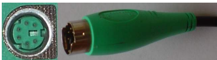
Slika 7.3.3 PS/2 priključci za kompjuterskog miša, ženski (levo) i muški (desno)
