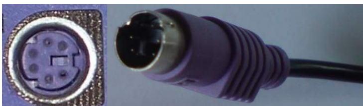
Slika 7.2.3 PS/2 priključci za tastaturu, ženski (levo) i muški (desno)
