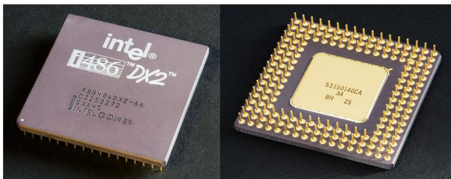
Slika 7.1.1.1.1 Mikroprocesor Intel 80486DX2 okrenut licem (levo) i naličjem (desno) prema nama, izdvojen od ostatka računarskog sistema
